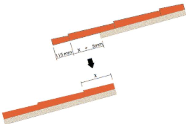
Corte de lámina y retiro de la espuma para realizar traslape
